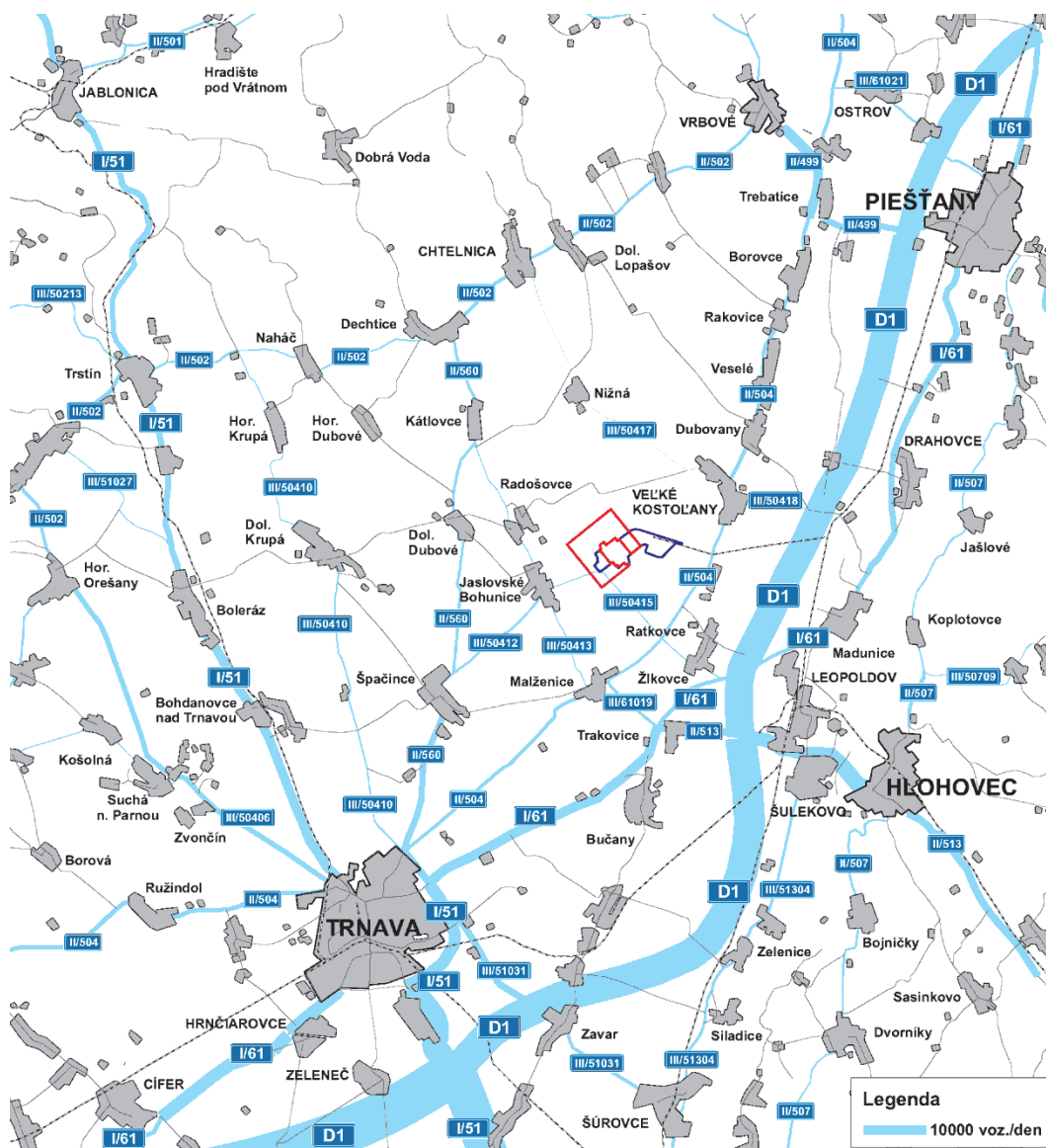
Obr. C.II.28: Cestná sieť v širšom záujmovom území (vrátane kartogramu intenzít dopravy pre rok 2010)
